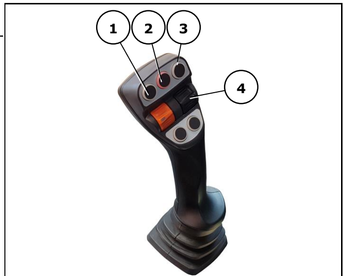
Abb. 5-147: Multifunktionshebel (Reinigungsmodus einschalten)
