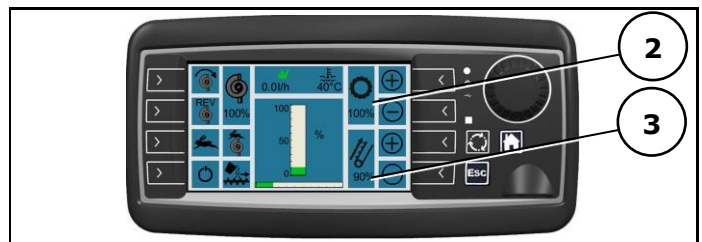
Abb. 5-127: Info- und Bedienterminal (Strukturwalze und Förderelevator ein-/ausschalten)
