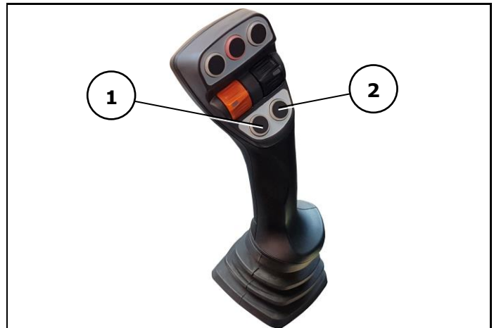
Abb. 5-132: Multifunktionshebel (Strukturwalze und Förderelevator reversieren)
