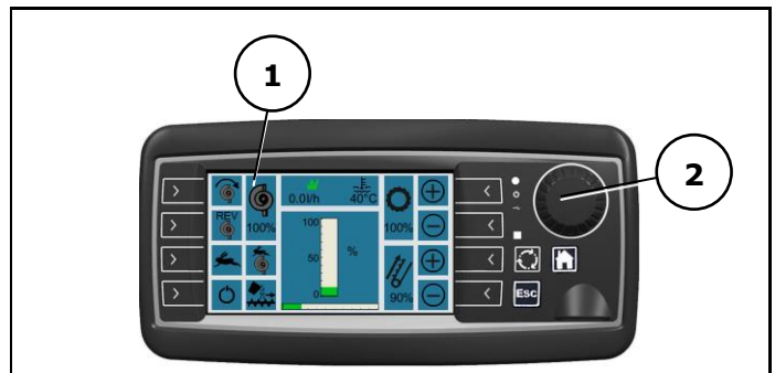
Abb. 5-144: Info- und Bedienterminal (Antriebsdrehzahl einstellen)
