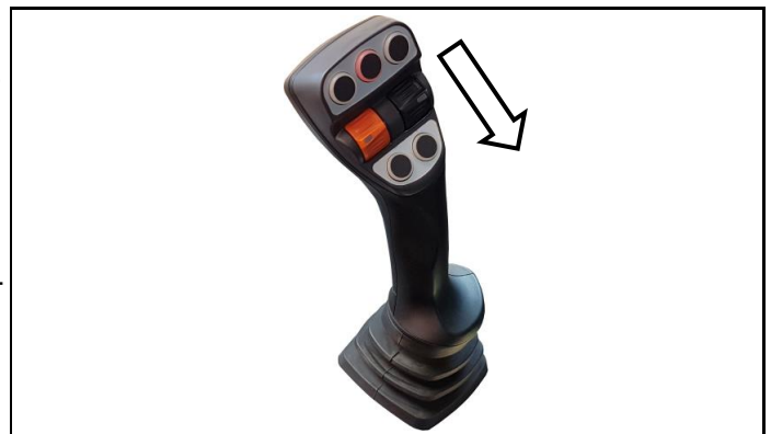
Abb. 5-122: Multifunktionshebel (Entnahmearm heben)
