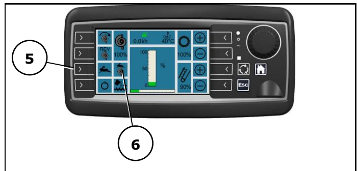
Abb. 5-148: Info- und Bedienterminal (Reinigungsmodus einschalten)
