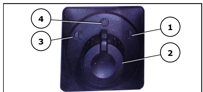
Abb. 5-113: Bedienelement Spiegel elektrisch einstellen
