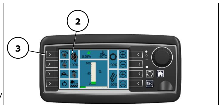
Abb. 5-143: Info- und Bedienterminal (Mischschnecke ein-/ausschalten)
