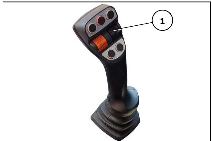
Abb. 5-131: Multifunktionshebel (Schutzeinrichtung Strukturwalze öffnen/schließen)
