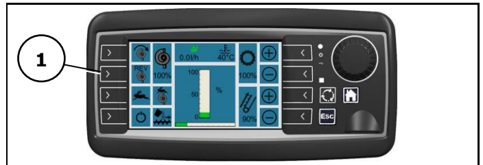
Abb. 5-149: Info- und Bedienterminal (Antriebsrichtung der Mischschnecke reversieren)
