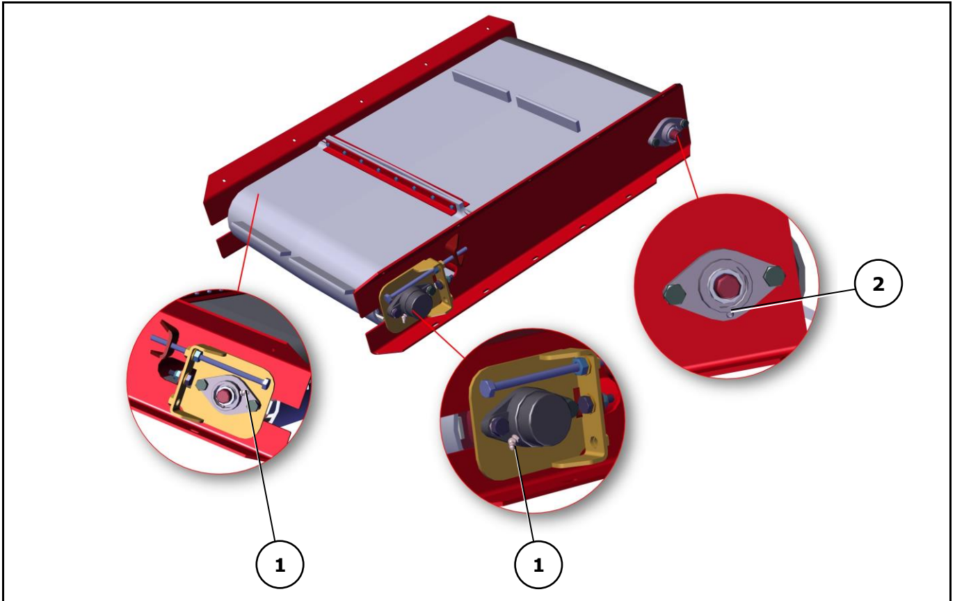
Abb. 9-22: Schmierstellen am Seitenelevator
