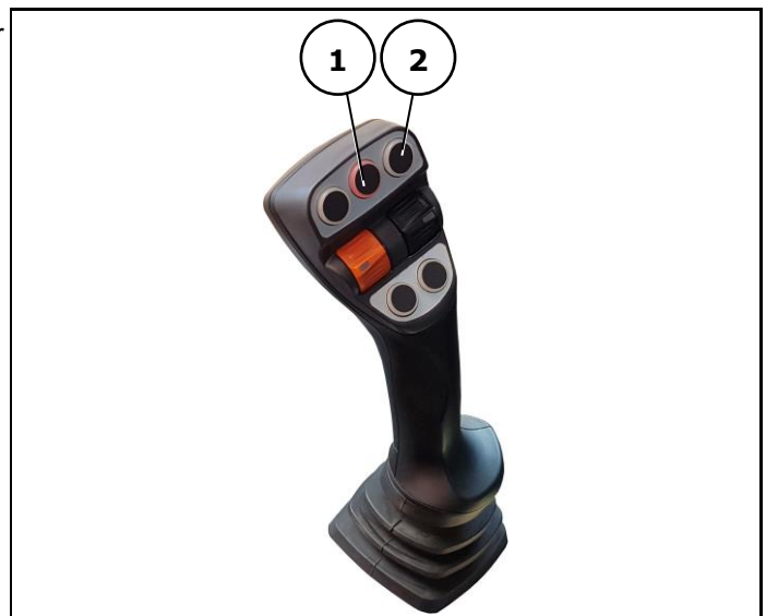
Abb. 5-129: Multifunktionshebel (Bandgeschwindigkeit erhöhen/verringern)
