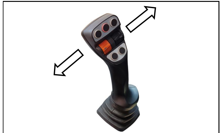
Ab. 5-140: Multifunktionshebel (Querförderband verschieben)
