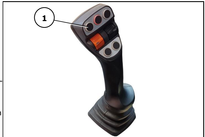
Abb. 5-126: Multifunktionshebel (Strukturwalze und Förderelevator ein-/ausschalten)
