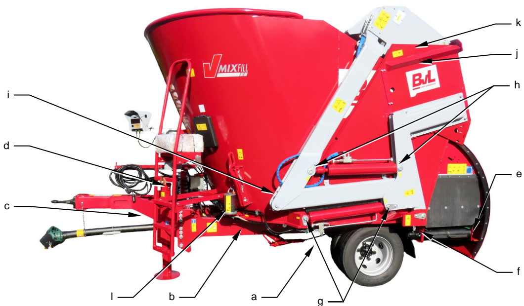
Abb. 8-1: Schmierplan der Maschine
