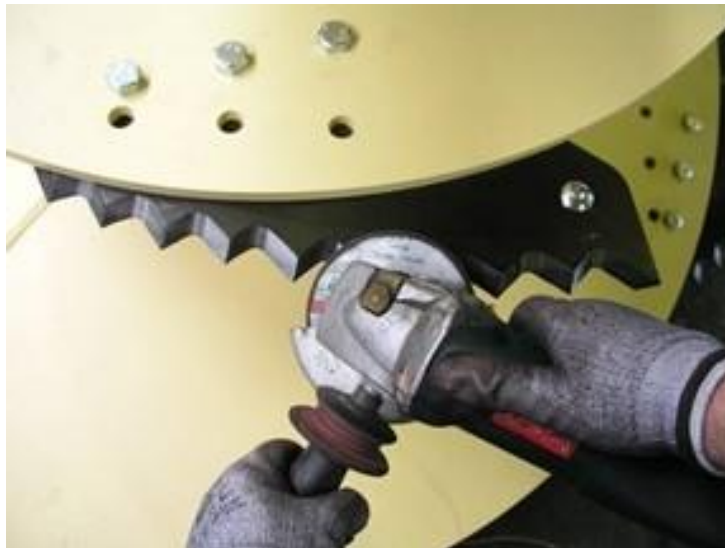
Abb. 8-29: Schneidmesser der Mischschnecke.
