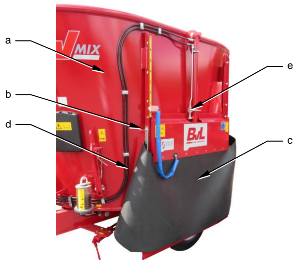
Abb. 8-27: Zugang zum Mischbehälter
