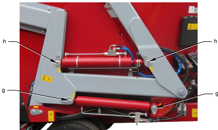
Abb. 8-8: Kugelgelenk am hydr. Zylinder der Ladeklappe und der Schneidrahmenschwinge
