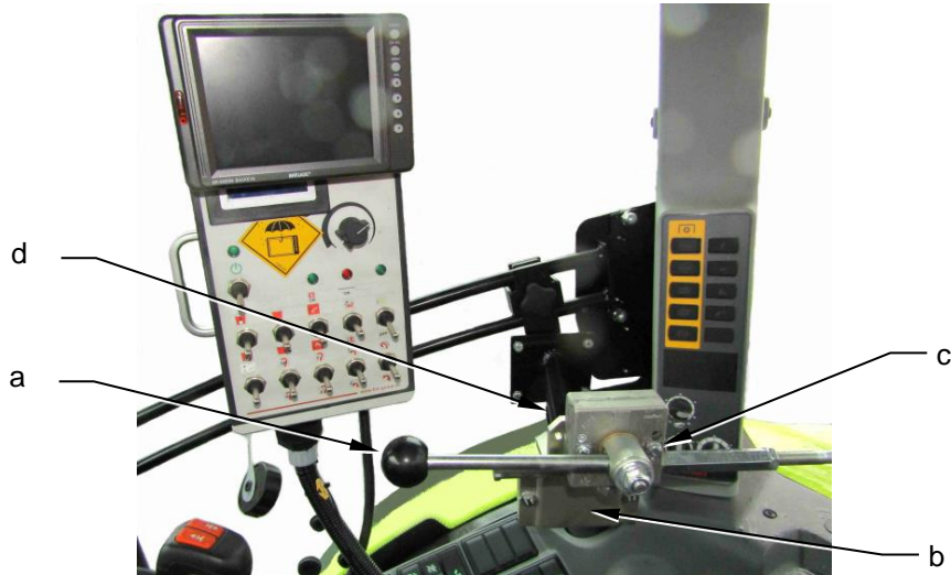
Abb. 6-9: Montage des Bedienhebels in der Traktorkabine
