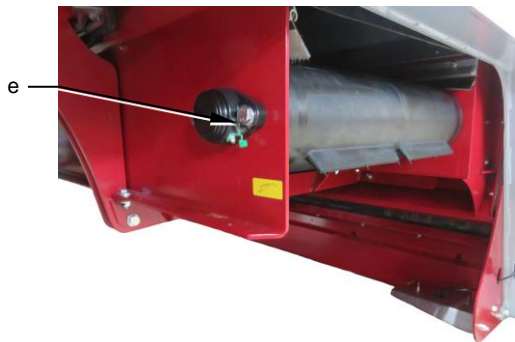
Abb. 8-6: Schmiernippel der Lager am Querförderband
