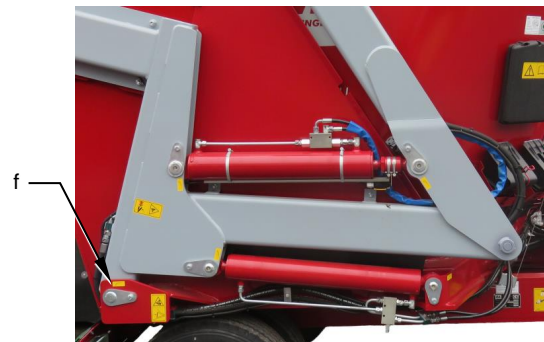
Abb. 8-7: Schmiernippel am Drehpunkt der Ladeklappe
