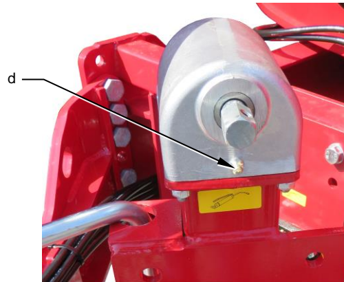
Abb. 8-5: Schmiernippel vom Stützfuß
