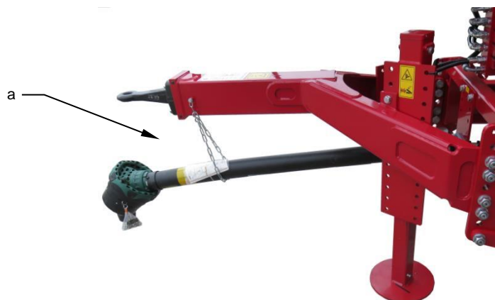
Abb. 4-48: Ablage für die Gelenkwelle
