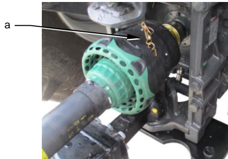
Abb. 7-6: Kuppeln der Gelenkwelle
