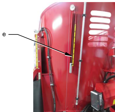
Abb. 7-25: Anzeige der Stellung des Dosierschiebers
