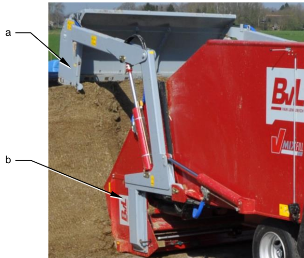
Abb. 4-18: Schneid- und Ladeeinrichtung
