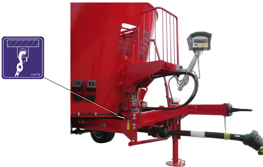
Abb. 5-1: Befestigungspunkte an der Maschine
