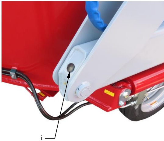
Abb. 8-9: Schmiernippel am Drehpunkt der Schneidrahmschwinge
