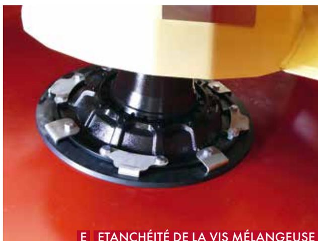
**E** ETANCHÉITÉ DE LA VIS MÉLANGEUSE
