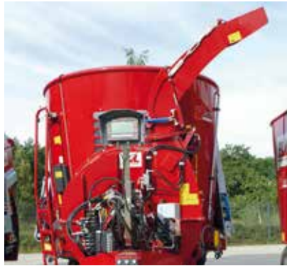
DREHBARER, KLAPPBARER TURM Drehbarer, kompakter Auswurf für einen flexiblen Auswurf zu allen Seiten.
